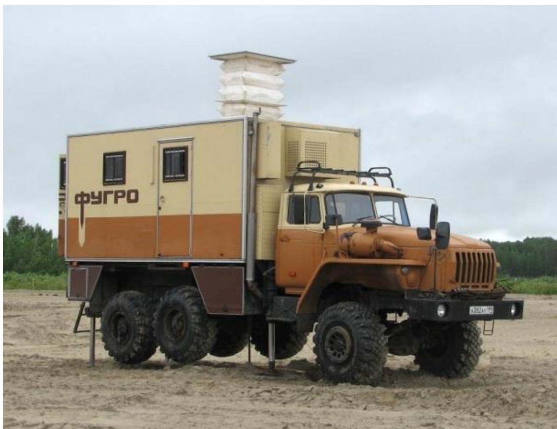
Рис.35. Установка статического зондирования.
